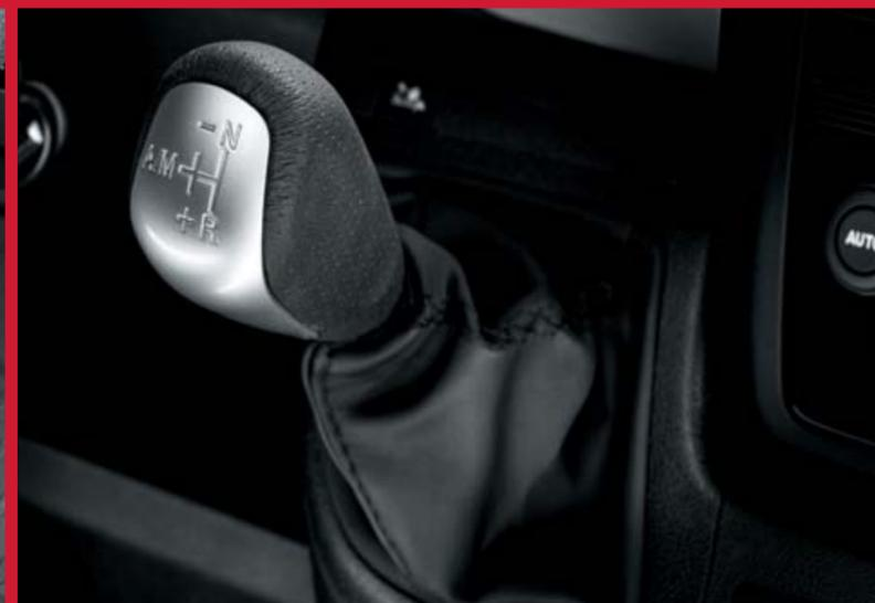
Das **automatisierte Schaltgetriebe Comfort Matic** sorgt vor allem im Stadtverkehr für maximalen Komfort, erhöhte Kraftstoffeffizienz und verringerte Emissionen. Mit seinen zwei Betriebsmodi – sequentiell oder automatisch – passt es sich jedem Fahrstil an.
