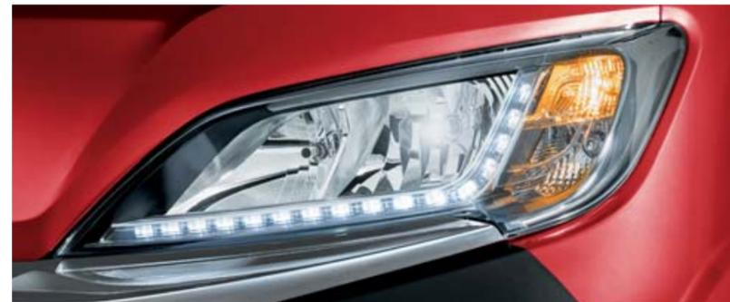
Die Scheinwerfer mit LED-Tagfahrlicht sind in einem stoßgeschützten Bereich untergebracht. Sie bewirken 40 % mehr Leuchtwirkung.
