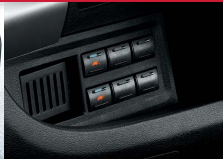
**Luftfederung.** Die Luftfederung an der Hinterachse gewährleistet eine konstant stabile Lage des Fahrzeugs, egal wie Sie Ihre Fracht verteilen. Bei stehendem Fahrzeug kann die Ladefläche für einfacheres Be- und Entladen gehoben bzw. gesenkt werden.
