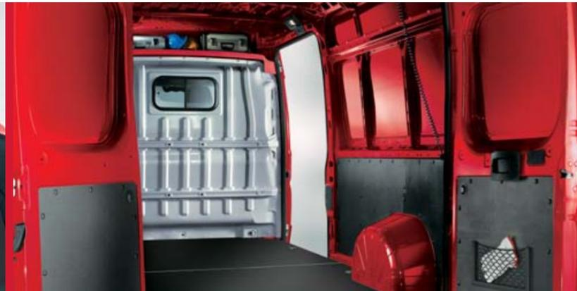
**Laderaum-Seitenverkleidung.** Die Innenwände des Laderaums können mit einem schützenden Kunststoffmaterial verkleidet werden.
