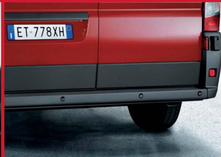
**Einparkhilfe.** Die Ultraschallsensoren der Einparkhilfe werden beim Einlegen des Rückwärtsgangs aktiviert. Ein Intervallton warnt den Fahrer vor Hindernissen.
