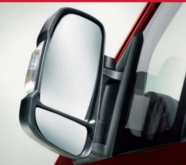
**Elektrisch anklappbare Außenspiegel.** Die Außenspiegel am neuen Ducato gewährleisten mit ihren beiden konvex geformten Spiegelgläsern einen Rundumblick nach hinten und sind zudem ganz praktisch zu bedienen, da sie von innen elektronisch eingestellt und angeklappt werden können. Beide Spiegel lassen sich unabhängig voneinander an die jeweiligen Bedürfnisse des Fahrers anpassen.
