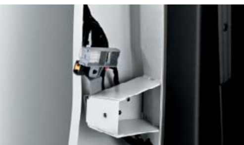
Vorverkabelung für Außenbauersteller mit Steckdose in der B-Säule (Opt. 081)
