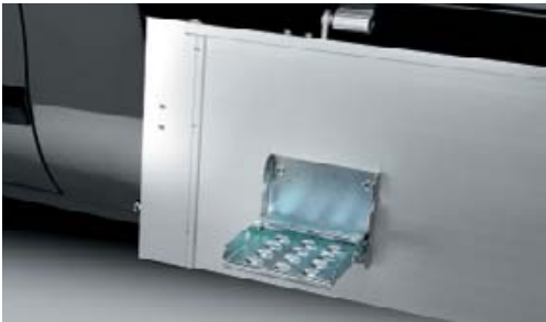
Kippbare Trittbretter auf der Innenseite der Pritschenwand
