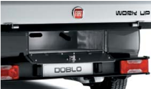
Verschließbares Staufach inkl. Löcher für Werkzeuge mit einer Länge von bis zu 2 m.
