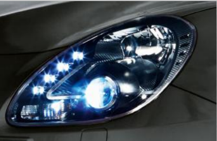
Bi-Xenon-Scheinwerfer mit LED-Tagfahrlicht (DRL) und dynamischem Kurvenlicht (AFS)
