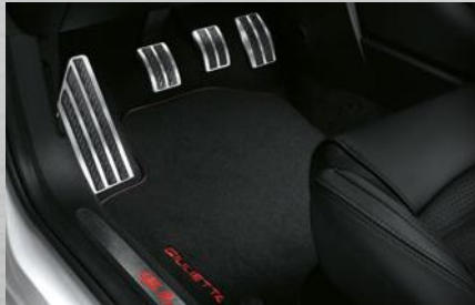
Sportpedale und Fußstütze aus Aluminium mit Gummi-Einsätzen für besseren Halt
