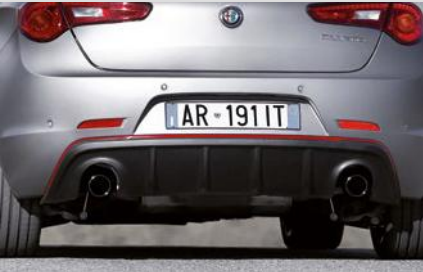
Abgasanlage, 2-flutig (links und rechts) nur bei 2.0 JTDm 20V 125 kW (170 PS) TCT Motorisierung verfügbar
