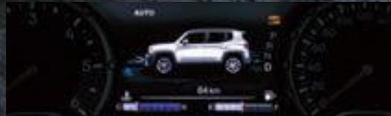
**AUTO** Der voreingestellte Auto-Modus meistert alle Alltagsituationen und schaltet bei Bedarf den Elektromotor an der Hinterachse für den Vierradantrieb hinzu.
