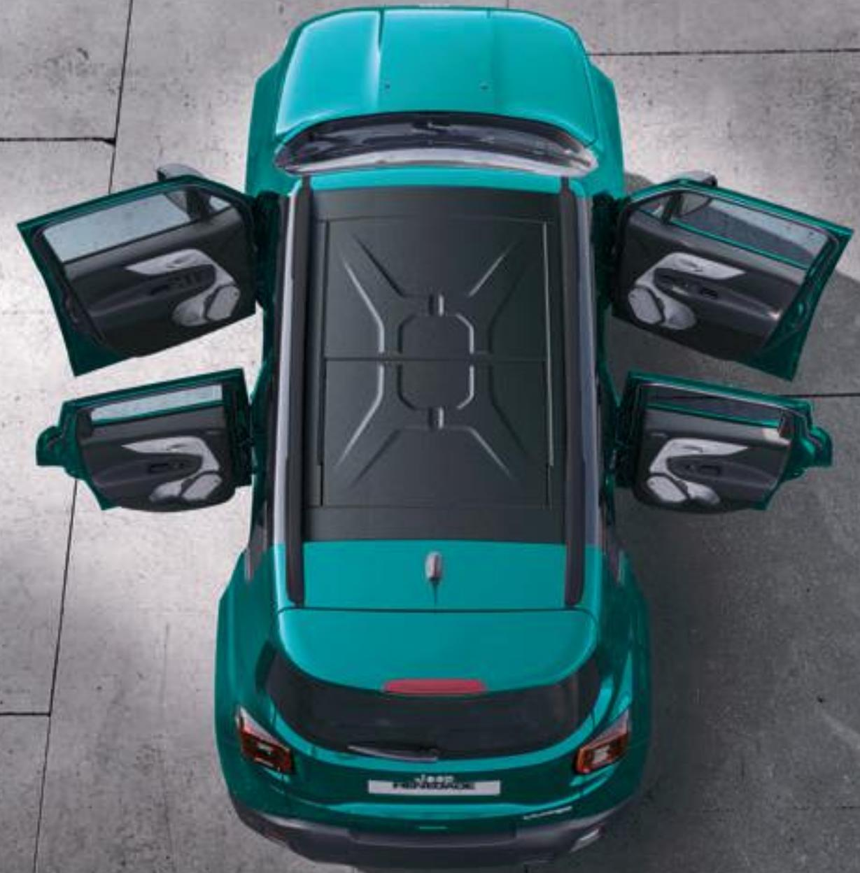
Das innovative MySky™-Schiebedach sorgt für neue Perspektiven. Denn die leichten Dachpaneele aus Fiberglas-Polyurethan lassen sich im Handumdrehen abnehmen und bequem und platzsparend in einer Tasche im Kofferraum verstauen. Für den kurzen Open-Air-Genuss zwischendurch funktionieren sie zusätzlich auch wie ein elektrisches Schiebedach.
