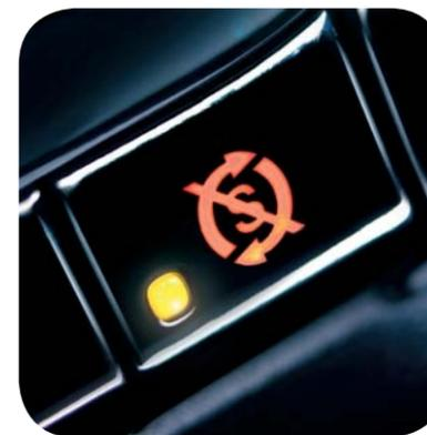
Der Fiat Panda steckt voller einfacher Lösungen, die jede Fahrt noch effizienter machen. Zum Beispiel die Start&Stopp-Automatik, die den Motor beim Warten an der Ampel oder bei stockendem Verkehr abschaltet und beim Wiederauffahren unverzüglich wieder startet, wenn bestimmte Parameter erfüllt sind.
