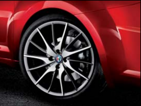
4AY - 18"-Leichtmetallfelgen TROFEO. 7,5J x 18 mit Bereifung 215/40 R18
