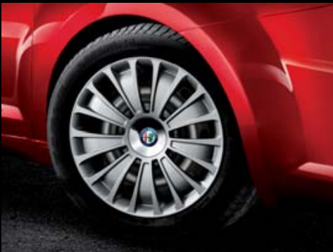
406 - 16"-Stahlfelgen mit Radabdeckung. 7J x 16 mit Bereifung 195/55 R16
